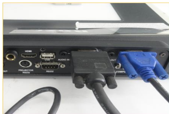
ภาพแสดงการเชื่อมต่อสายสัญญาณต่าง ๆ เข้ากับเครื่องฉายโปรเจคเตอร์
