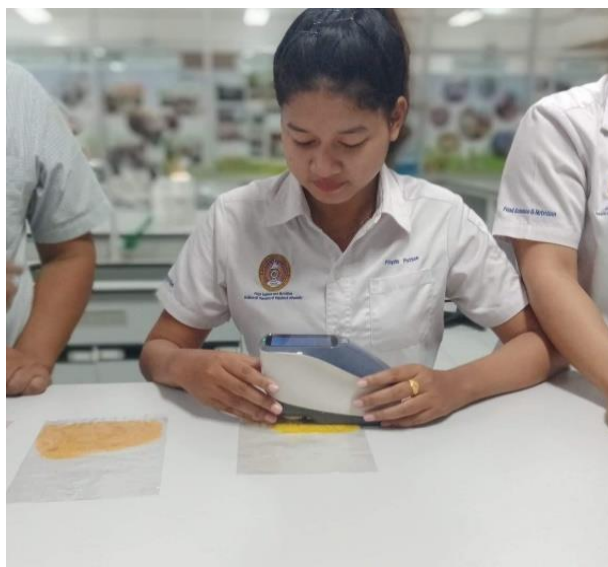
การวิเคราะห์คุณภาพ (ค่าสี) ของข้าวเกรียบหมูน (ส่วนหนึ่งของรายวิชาการควบคุมและประกันคุณภาพอาหาร)
